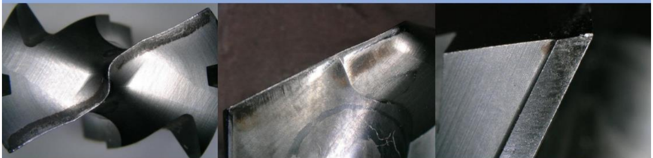
KTIP2000HPM:KCP15A+コーティング+ルブロイド処理 40ワーク加工後写真
