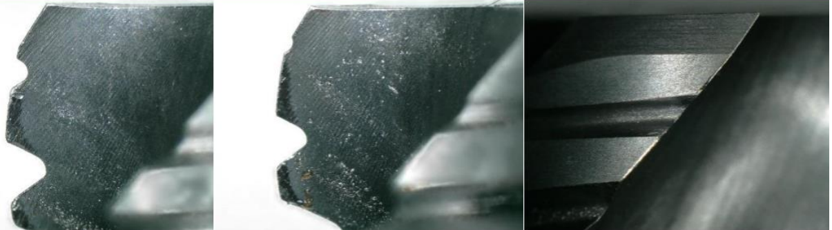
OSG A-SFT M14X2 標準品 32ワーク加工後写真
