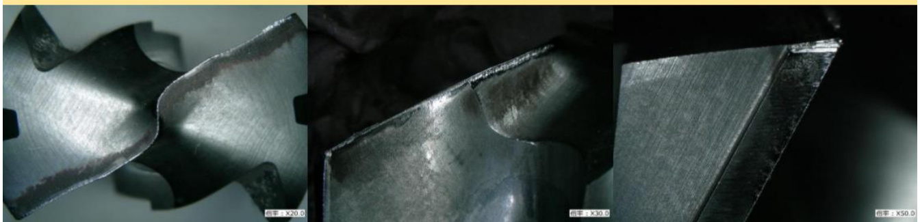
KTIP2000HPM:KCP15A+コーティング 30ワーク加工後写真
